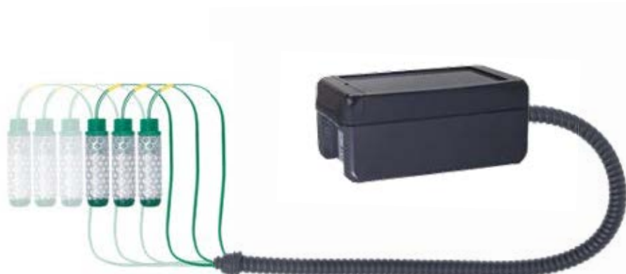
Der PiCUS Tension kann mit bis zu sechs robusten Sensoren ausgestattet werden
